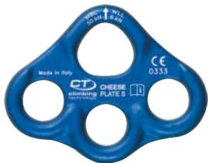
**DE** Heiß geschmiedete Platte mit Mehrfachanschlagpunkten aus Aluminiumlegierung mit 3 unteren Öffnungen. Die zentrale, obere Öffnung eignet sich für das Einfügen von bis zu 3 Verbindungselementen.
