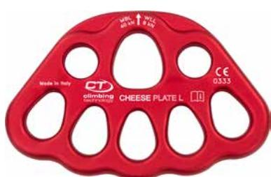
**DE** Heiß geschmiedete Platte mit Mehrfachanschlagpunkten aus Aluminiumlegierung mit 5 unteren Öffnungen. Die zentrale, obere Öffnung eignet sich für das Einfügen von bis zu 3 Verbindungselementen.
