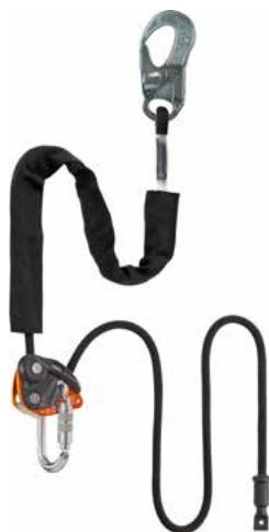
**DE** Verbindungsmitte für Höhenarbeit mit Karabiner. Kann als Positionierungsmitte, Anschlagvorrichtung und horizontales Geländerseil verwendet werden. Ebenso möglich sind kurze Abseilstrecken.
